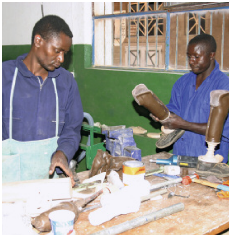
Aus Holz und Plastikteilen werden einfache Prothesen gefertigt.
