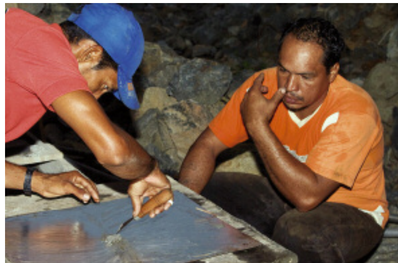
Die Ernte: Das Amalgam wird von der Messingplatte gekratzt.
